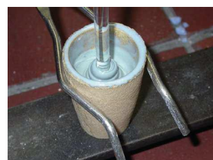
c) 形成熔球 (熔合结束)
